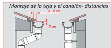
El material del techo /teja, chapa, etc. / debe entrar en el canalón no más de 4 cm.
