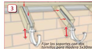
3. Para el montaje sobre vigas o techos planos se utilizan los soportes verticales u horizontales. Con la tuerca y tornillo M6 (pos. 16) ajustar hasta la inclinación necesaria del canalón.
