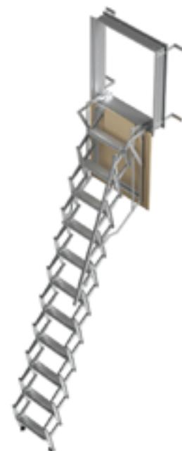
Escalera abatible de pared compuesta por 10 peldaños y estructura móvil, fabricada en chapa de acero galvanizado 15/10 y con muelles amortiguadores que facilitan la apertura y cierre de la escalera.
