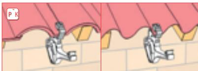
3b. Para instalar el canalón directamente en las tejas o en cubiertas onduladas, utilice los soportes metálicos para tejas. Para ajustar fácilmente la inclinación del canalón, utilice tornillo y tuerca M6x50 que fijan los ganchos / soportes del canalón a los soportes metálicos.
