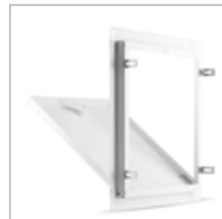
Las trampillas metálicas son hechas en chapa electro zincada de Aluminio 0.6mm, con una aplicación de una pintura termo lacada en color RAL 9010 blanco.
