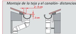
El material del techo /teja, chapa, etc. / debe entrar en el canalón no más de 4 cm.
