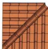
Limatesa: Debe ser instalados en la línea central entre las tejas.
