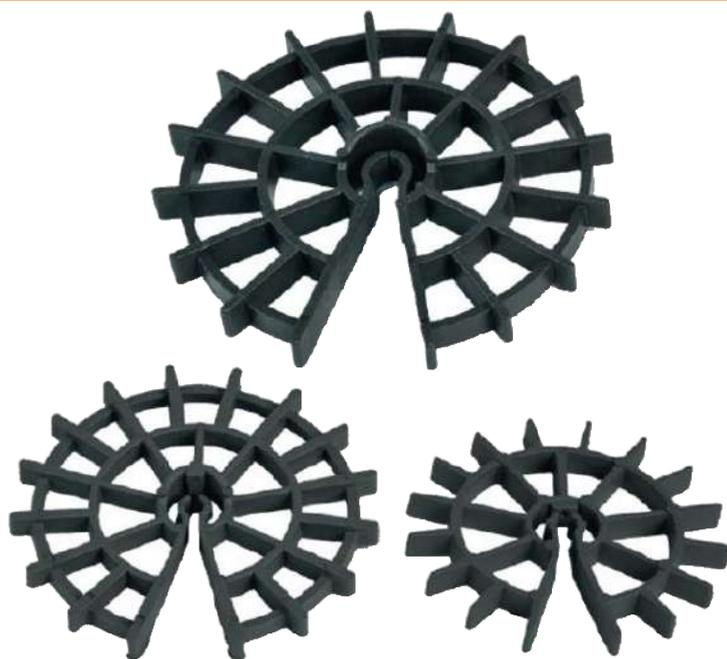
Separador fabricado en plástico resistente con forma circular o timón. Se utiliza para de separar las armaduras de acero de los encofrados para establecer el recubrimiento necesario en pilares, muros y elementos verticales fabricados en hormigón o concreto armado.
