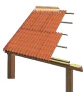
La segunda línea de teja debe ser cortada por la mitad longitudinalmente para alinear con el siguiente panel y así no permitir la colocación de cuatro paneles.
