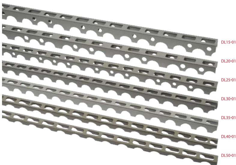
Estas piezas son utilizadas en las armaduras para mantener una distancia mínima requerida entre la armadura y el encofrado, garantizando el recubrimiento exigido y la conservación de las armaduras, así como la contribuyendo a la vida útil de la estructura.
