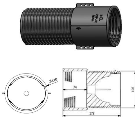
**GB-K-CL** Pieza de conexión/extensión 180mm
